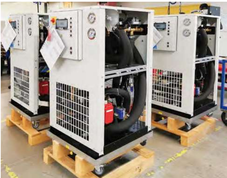
Thermorégulateurs +20°C/+125°C pour l'industrie automobile électrique (mini série).
