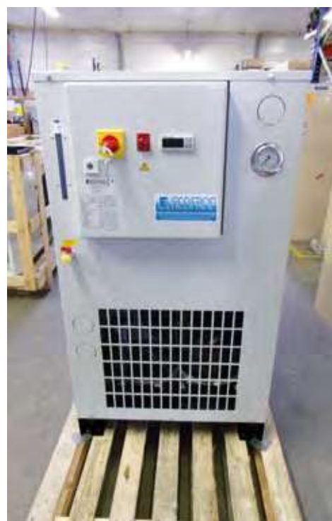
Une belle configuration pour l'export (Californie) : un refroidisseur d'eau 3 kW destiné à un process laser en environnement pollué.
