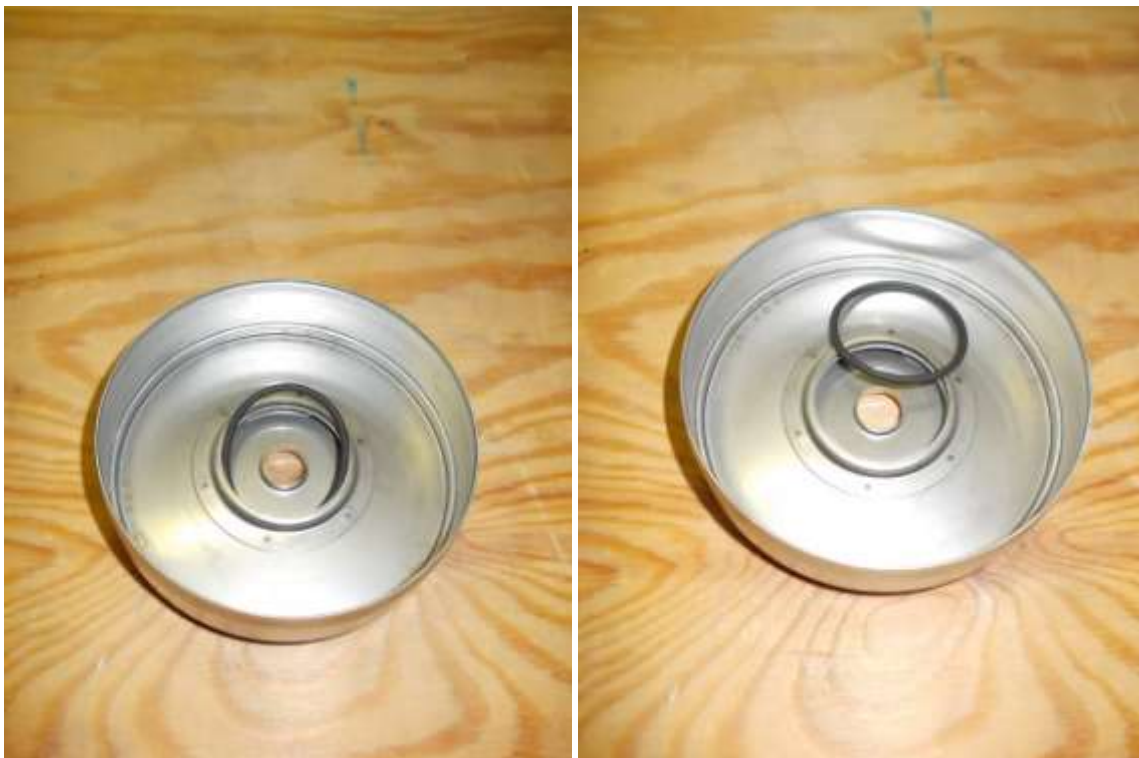
Remplacer le joint des 2 flasques par les neufs manuellement.
