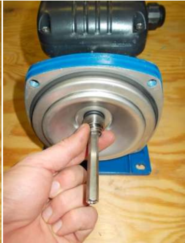
Positionner la garniture au fond de l'axe.
