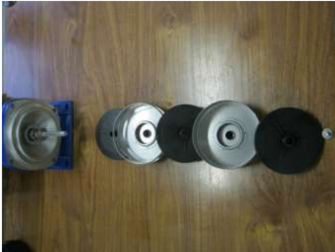
Vue de tous les flasques et roues retirés.
