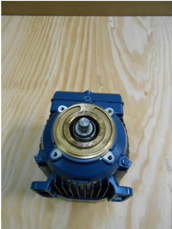
Vue de la pompe avec circlip mis en place
