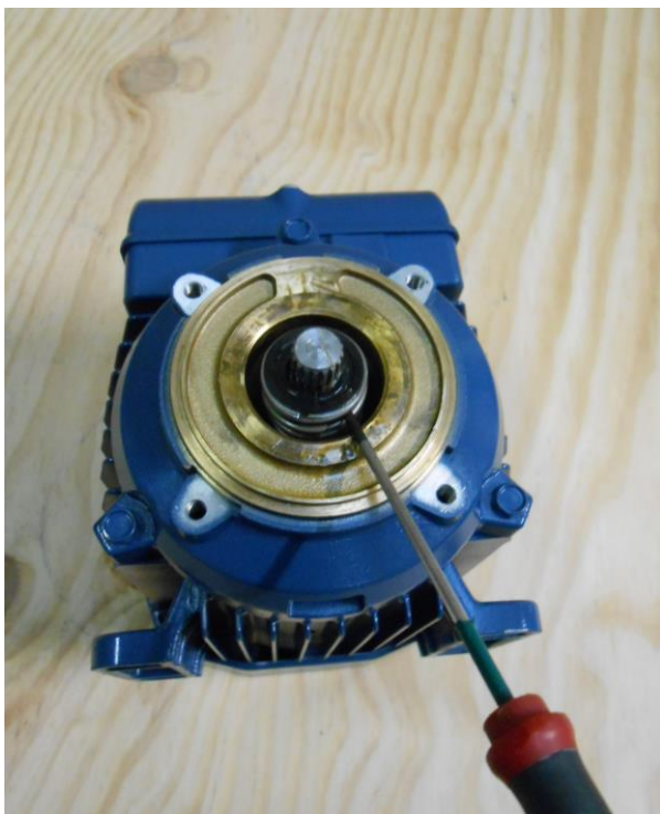
Enlever la garniture mobile avec le tournevis plat
