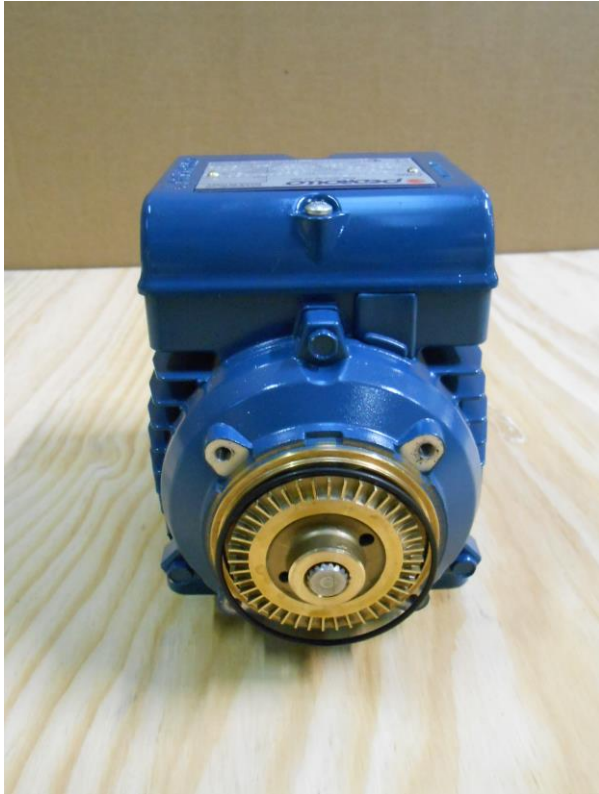
Enlever le joint d'étanchéité du corps de pompe
