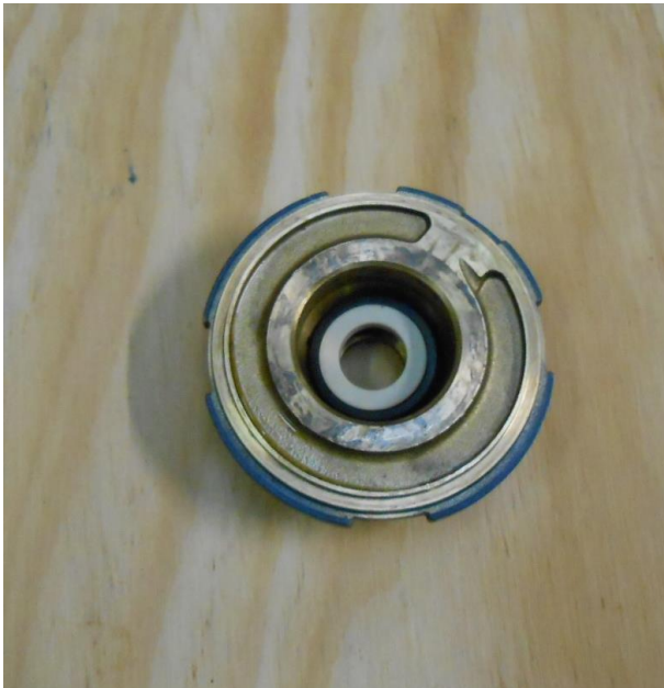
Placer la nouvelle garniture manuellement
