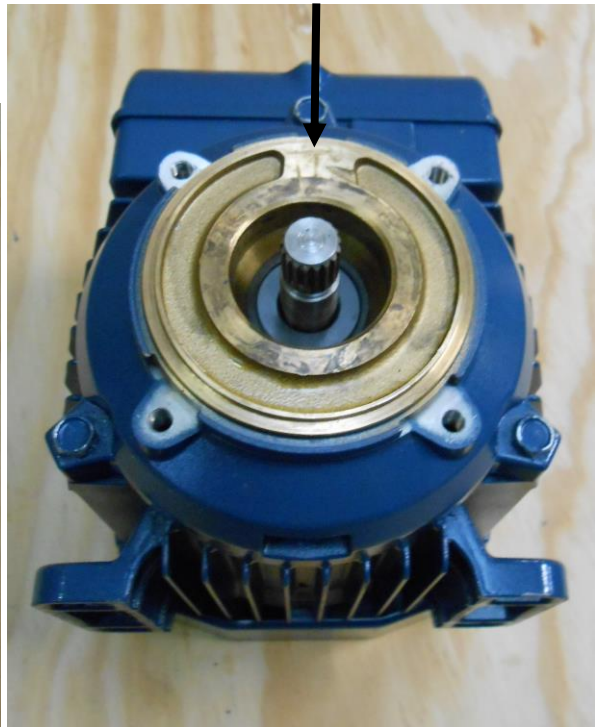
Replacer le corps de pompe dans le moteur, en laissant la partie plein en haut
