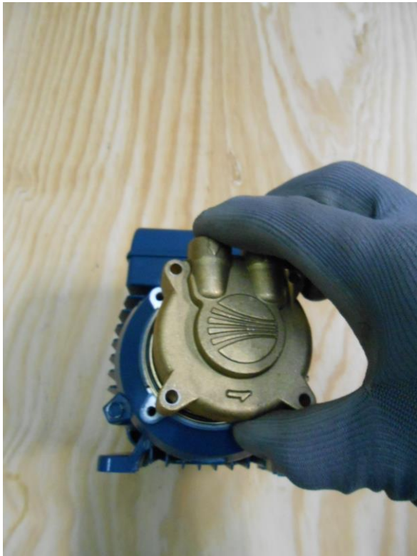
Mettre en place le corps de pompe sur la pompe
