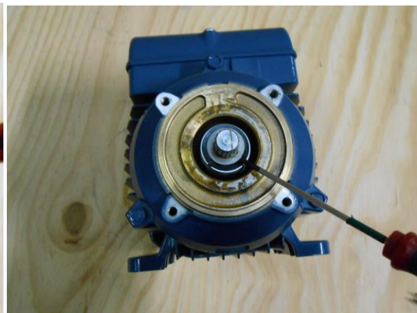
Enlever la rondelle de protection avec le petit tournevis (2)
