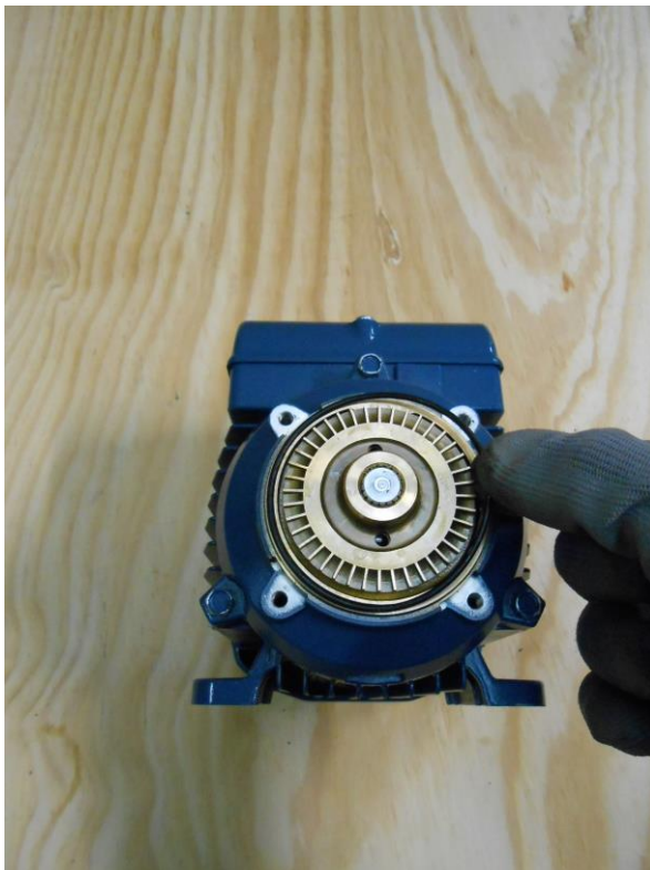
Repositionner le joint sur la pompe
