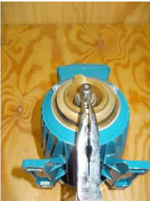
À l'aide de la pince circlips (4) ôter la bague qui maintient la garniture
