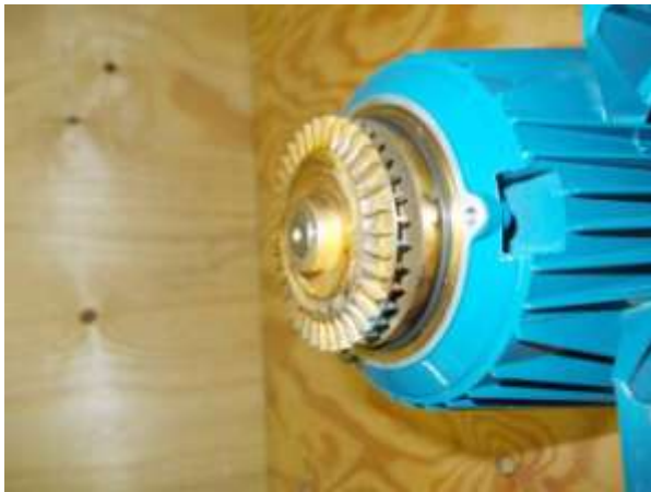
Replacer la roue sur la pompe manuellement.
