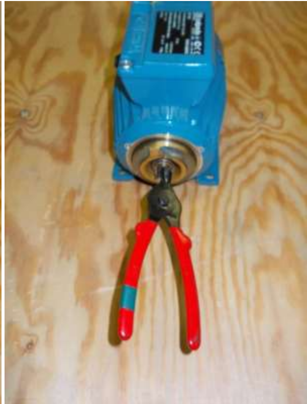
À l'aide de la pince circlips (4) ôter la bague qui maintient la garniture
