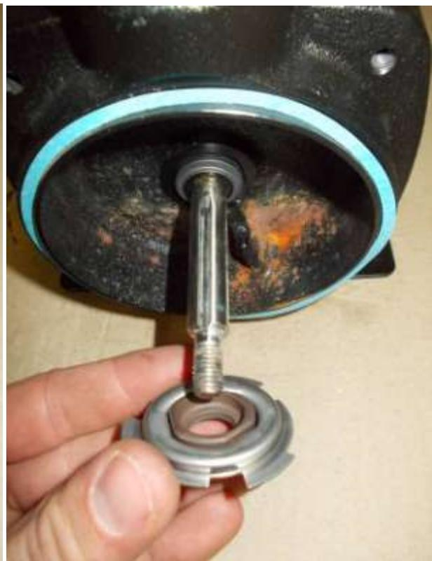
Retirer la garniture de pompe manuellement et la remplacer par la neuve
