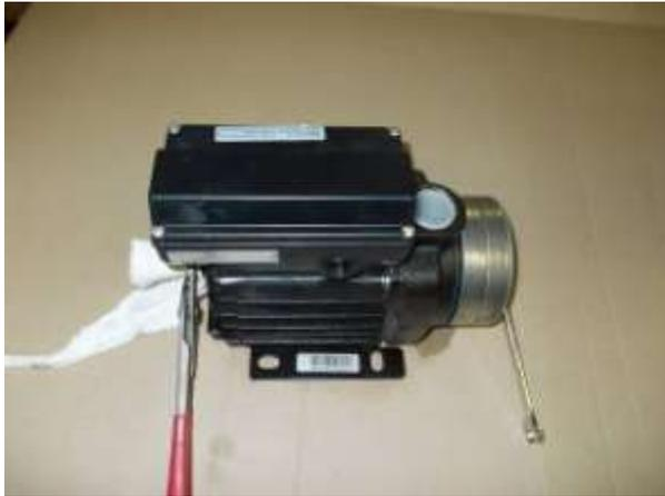
Desserrer l'axe de la pompe à l'aide de la pince multiprise (3) et de la clé plate (2) ; prévoir un chiffon afin d'éviter d'abimer l'axe
