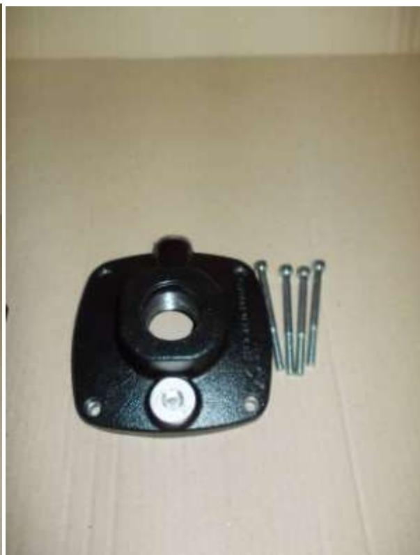
Vue de face : avant du corps de pompe démonté
