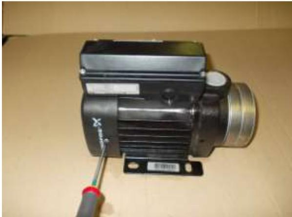
Pour retirer le cache arrière de la pompe utilisé le tournevis plat (4)
