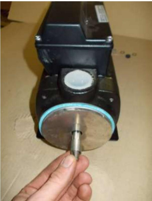
Mettre le cylindre manuellement sur la pompe et placer un joint bleu sur cette roue
