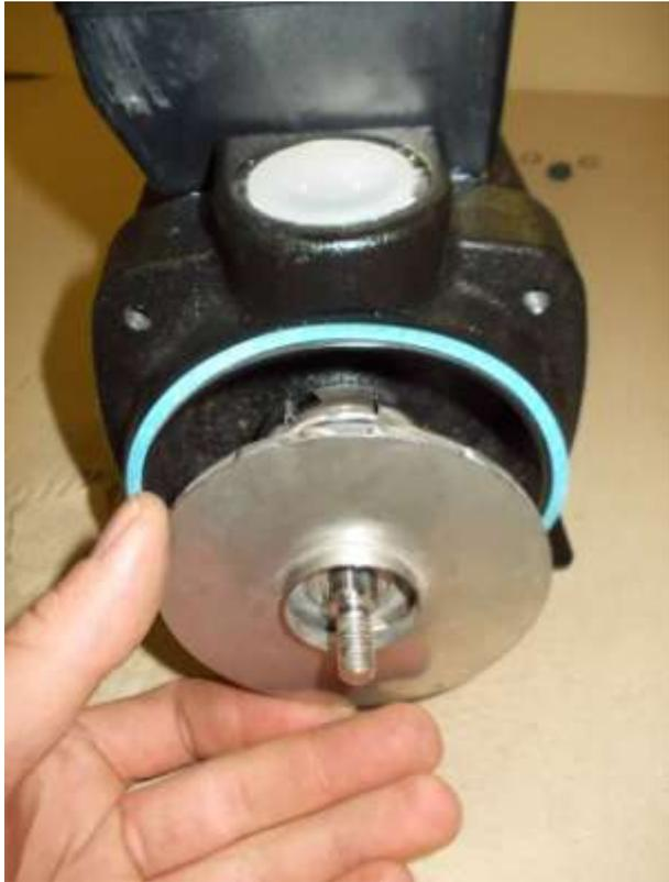
Mise en place de la première roue manuellement
