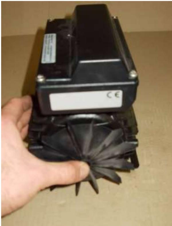
Remonter ventilateur du moteur manuellement
