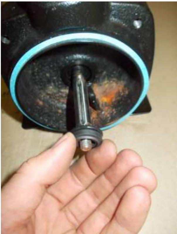
Placer la nouvelle garniture manuellement et remplacer le joint d'étanchéité (en bleu)
