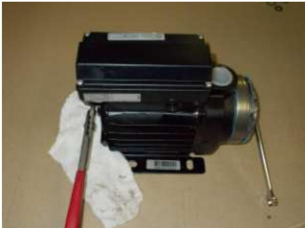
Serrer l'écrou à l'aide de la clé plate (2) et de la pince (3)
