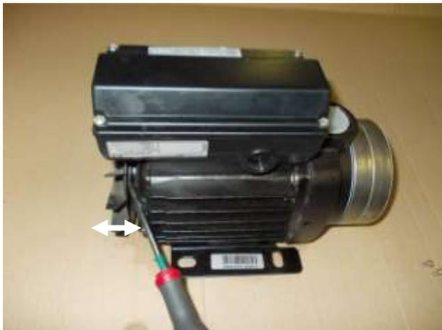
Retirer le ventilateur arrière grâce au tournevis plat (4) en faisant levier
