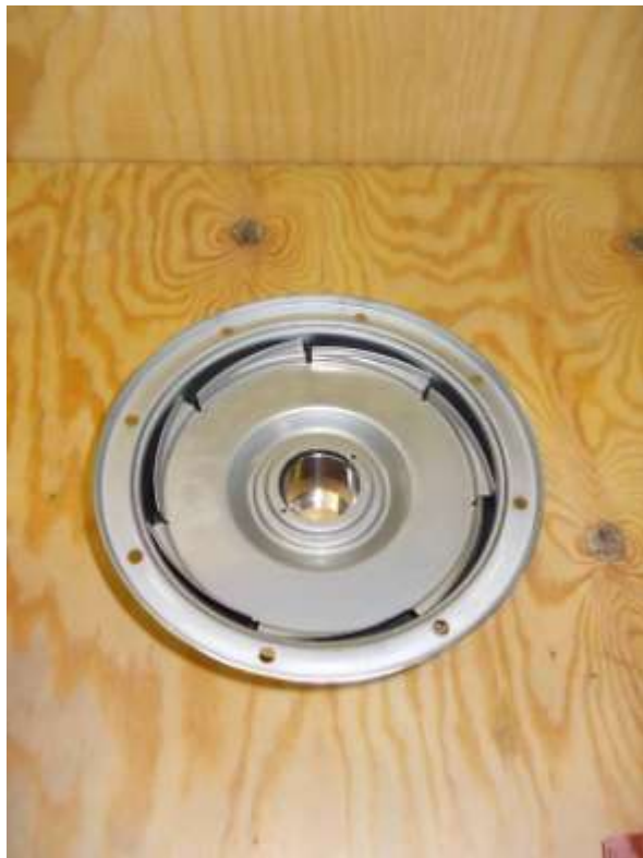
Vue de la seconde partie du corps de pompe démonté
