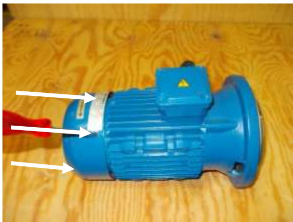
Retirer les 3 vis du carter de protection du ventilateur à l'arrière de la pompe, avec la clé à tube(3)
